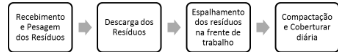
Figura 310: Etapas da operação da célula emergencial do aterro Morro do Céu.
